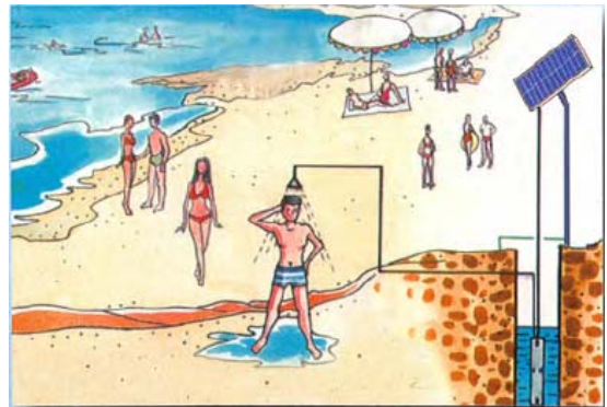
Suministro de agua para pequeñas duchas en la playa
